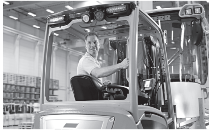
Geri sürüşler için isteğe bağlı kornalı tutacaklı dönel koltuk
