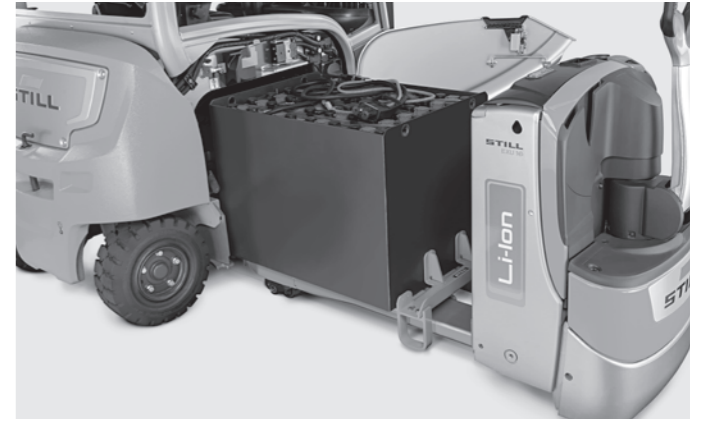
Elektrikli transpalet ile akü değişimi
